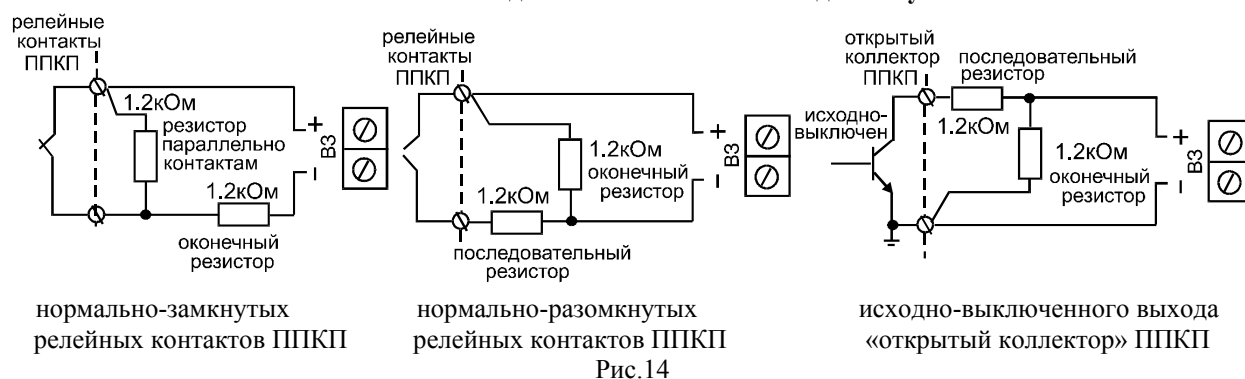
Схема подключения ППКП ко входам запуска
