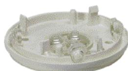
Монтажная пластина для подготовительного монтажа кабеля, с защитой от капель и фиксаторами для приема баз извещателя от 781590 до 781594 и RAS 782103. Крепеж: прищелкивание на пластину 781495 или 2 винта / расстояние 60 мм, напр. 4,0 x 30 DIN 96/ дюбель S 6.
