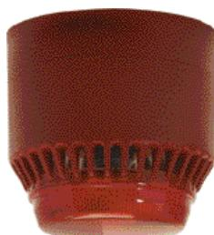
Сирена согласно DIN 33404 часть 3; или EN 457. Для внутреннего и внешнего монтажа (с 766237). Возможно раздельное управление сиреной и лампой-вспышкой. Скользящий звук в такте 1 Гц между 1200 и 500 Гц (DIN звук).
