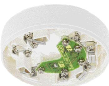
База извещателя с релейным контактом на выходе, для серии 9200. Контакт: бесполюсный, выбор с помощью кодирующей перемычки - нормально замкнутый или разомкнутый, заводская установка - замыкающий контакт. Крепеж: прищелкивание на пластину 781495 или 2 винта / расстояние 60 мм, напр. 4,0 x 30 DIN 96/ дюбель S 6.
