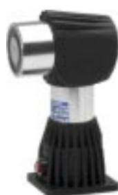
Для противопожарных дверей и ворот, с распорной трубкой (до 175 мм), кнопка обрыва, защита от переполюсовки и встроенной кнопкой срабатывания. Монтаж: настенный, на потолке, напольный (регулируется для настенного монтажа).
