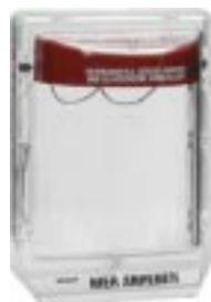
Данная защитная крышка защищает от ложных тревог, не мешая подавать сигналы реальной тревоги. Приспособление состоит из рамки, защищенной от манипуляций, выполненной из прозрачного поликарбоната и крышки, которая легко надевается на ручной извещатель, установленный посредством врезного, или накладного монтажа. Она обеспечивает защиту от случайных ложных тревог, от вандализма, пыли и воды.
