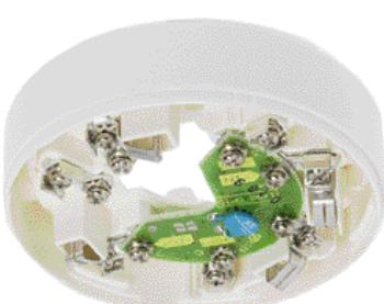
База извещателя с оптовыхходом, для извещателей серий 9000 и 9200. Оптовыхход: бесполюсный, в покое высокоомный, для серии 9200 в активном состоянии пульсирующий. Крепеж: прищелкивание на пластину 781495 или 2 винта / расстояние 60 мм, напр. 4,0 x 30 DIN 96/ дюбель S 6.
