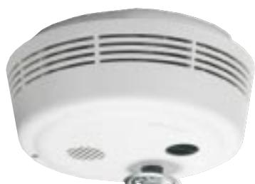
Дымовой извещатель рассеянного света с термомаксимальным контактом, встроенным сигнальным устройством и тестовым переключателем для проверки работы извещателя. Извещатель предельных значений для работы от сетевого напряжения. Поставка с монтажной пластиной и штекером. Монтаж осуществляется в розетку для скрытого монтажа (d = 30 ... 80 мм) на потолке или на стене. Автономный извещатель (без BMC), возможно объединение сигнальных устройств нескольких извещателей (3-проводная линия, L1/N/SYNC).
