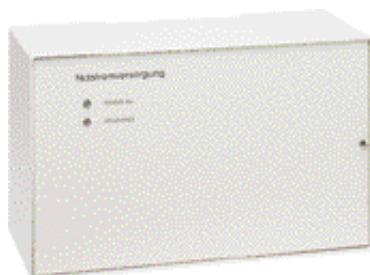
Компактное устройство аварийного электропитания с полностью электронным стабилизированным блоком питания/зарядным устройством для резервного режима параллельной работы в стабильном корпусе из листовой стали, вкл. аккумуляторы/аккумуляторы для накладного монтажа. Аккумуляторы, отправляемые при поставке отдельно, являются необслуживаемыми, закрытыми аккумуляторами с твердым электролитом. Они не зависят от положения, долговечны (4-5 лет) и работают при высоких нагрузках.
