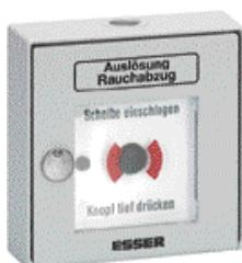
Кнопка срабатывания RWA служит для ручного срабатывания систем дымоотвода и отвода тепла. Техническая конструкция по DIN 14655/G с контрольной лампой, для врезного монтажа внутри помещений, возможны надписи на иностранных языках.
