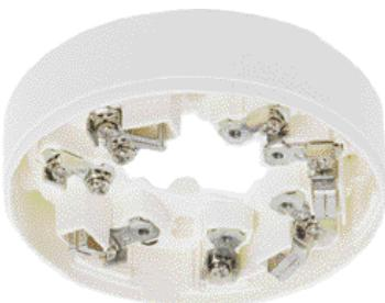
Основная модель базы извещателя для серий 9000 и 9200, клеммы для подключения параллельной светодиодной индикации извещателя 781803 (для серии 9000 необходим блок подключения 781487). Крепеж: прищелкивание на пластину 781495 или 2 винта / расстояние 60 мм, напр. 4,0 x 30 DIN 96/ дюбель S 6.
