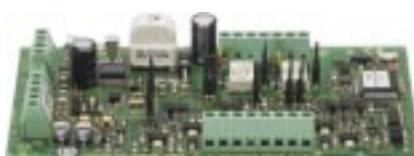
Модуль подключения извещателей других производителей является самостоятельным абонентом на шине esserbus® КП пожарной сигнализации системы 8000. Возможно индивидуальное подключение автоматических пожарных извещателей и ручных извещателей (технология предельных значений) других производителей на 4 групповых входа. Через внутренний модуль DC / DC возможна конфигурация напряжения всех 4 групп на 18 В, 24 В. Для работы извещателей других фирм не требуется дополнительный модуль сброса.
