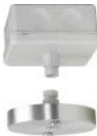
Монтажный узел для баз извещателей от 781590 до 781594 и 801593 для навесного монтажа, со стабилизатором раскачивания, кабельный ввод сверху, винтовое соединение Pg, включена клеммная розетка с набором клемм. Высота извещателя регулируется индивидуально длиной кабеля. Стабилизатор: Alu, Ø = 84 мм, В = 15 мм. Винтовое соединение Pg 7.
