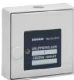
Обработка, передача и индивидуальная индикация технической тревоги (TAL) специально для требований, предъявляемых к абоненту шины на многофункциональном первичном шлейфе системы пожарной сигнализации 8000. Блок TAL содержит изолятор для ограничения неисправностей на многофункциональном первичном шлейфе. Имеются один оптовход и один внешний вход извещателя D.
